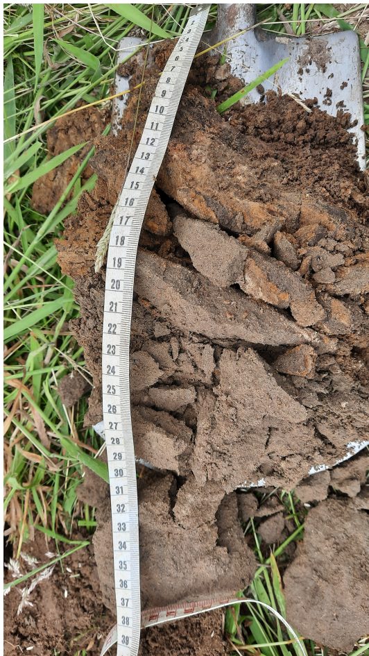
Sterk verdichte zandbodem. Scherpblokkige structuur. Deze bodem is wat grijs van kleur en rook naar rotte eieren.
